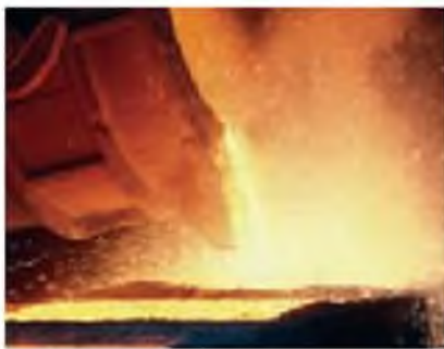
▲ Figura 23.5 Hierro fundido en altos hornos. El hierro se vierte para transportarlo a un convertidor de oxígeno básico. Los fabricantes de acero convierten el hierro en acero agregando chatarra de acero y otros metales como agentes de aleación.
